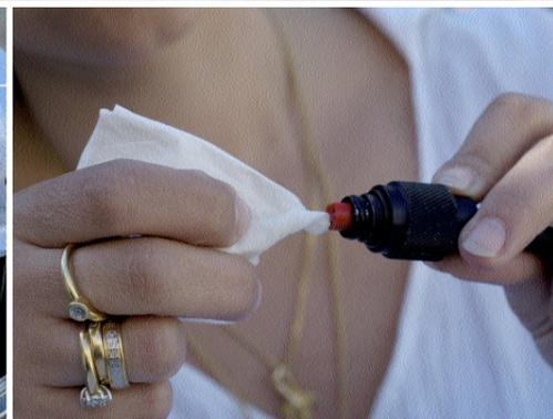
Metalteile, die mit „WD-40“ behandelt werden, sind gegen Korrosion hervorragend geschützt (links). Damit die Stecker nicht oxidieren oder einen leichten Fettsfilm bekommen, werden sie mit einem weichen, mit Alkohol getränkten Tuch gereinigt
