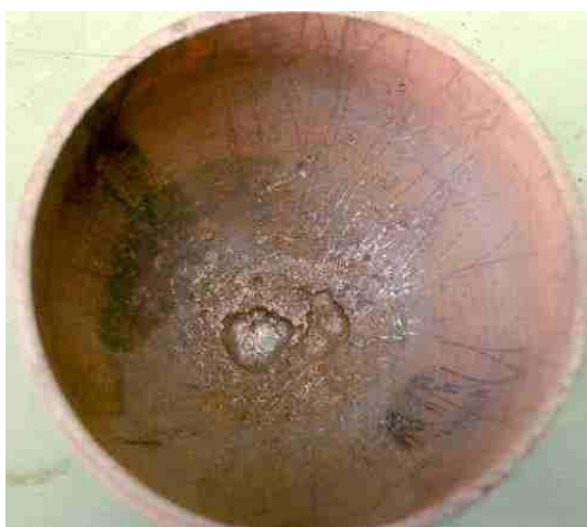
Lochfrass im Boden einer Taucherflasche
